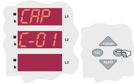
Kademe menü seçeneğinin ayarlanan ilk parametresi 1. kondansatör ayarına (C-01) geçmek için "SET" tuşuna basınız.
